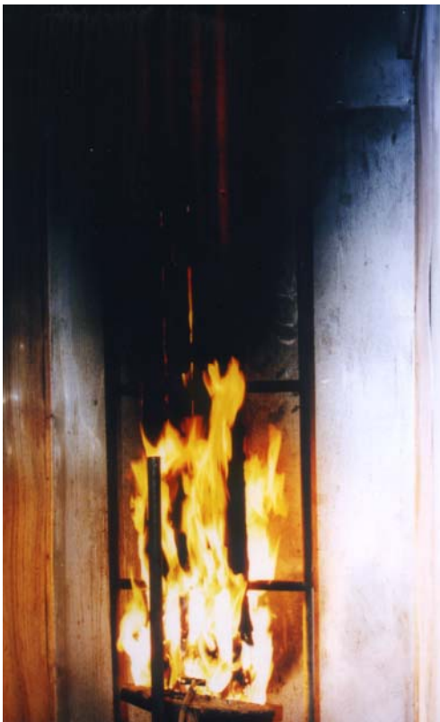
Cable convencional. No supera el ensayo de no propagación del incendio, todo el cable resulta dañado.
