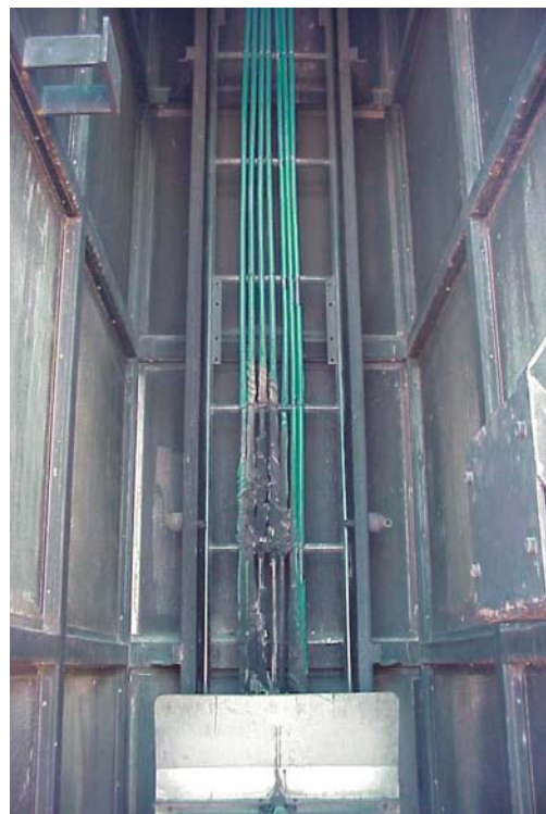
Cable alta seguridad (AS). Supera el ensayo de no propagación del incendio, sólo una mínima parte del cable resulta dañada
